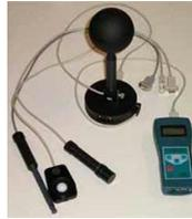
Рис. 3.13. Гигрометр М-19(а) и метеометр МЭС-200(б)
