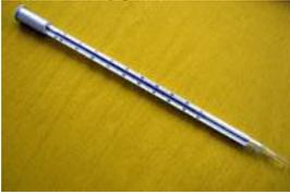
Рис.3.9. Термометр ТМ-1
