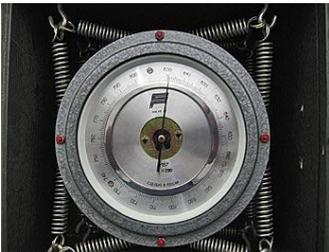
Рис. 3.10 Барометр-анероид контрольный М-67
