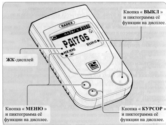
Рис. 8. Устройство индикатора радиоактивности «РАДЭС»
